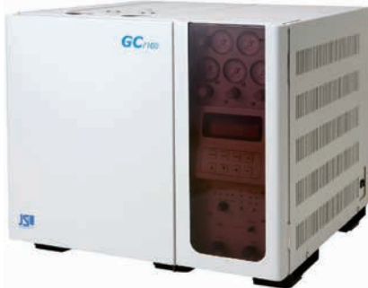
LPガスの品質試験機器例：汎用ガスクロマトグラフ (GC-7100 (株)ジェイ・サイエンスラボ/(株)ジェイ・サイエンス東日本)
