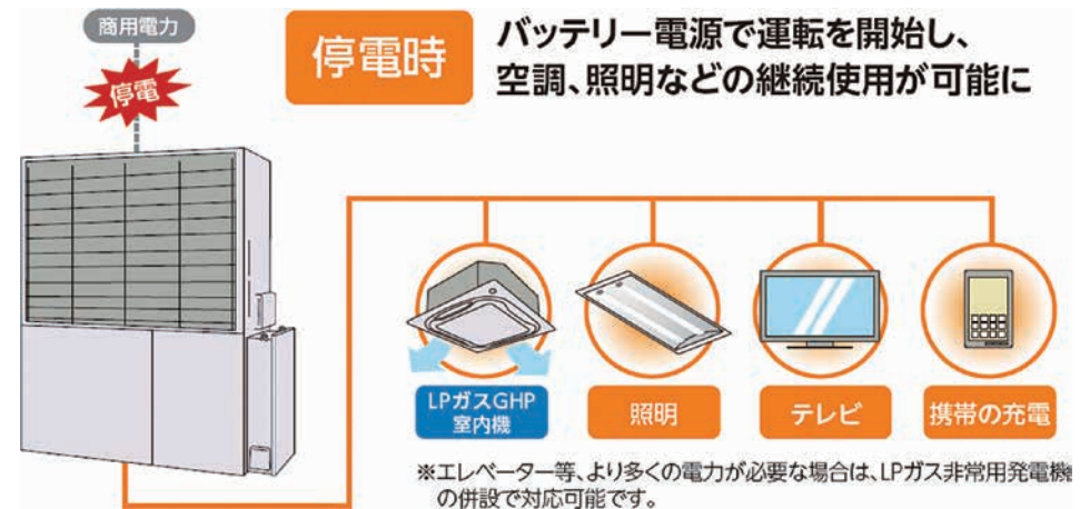
■災害に強いLPガス仕様の電源自立型GHP(発電機能を持つガスヒートポンプ)
