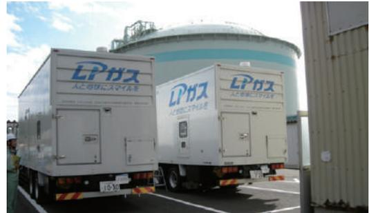
新潟ガスターミナルで行われた移動式電源車2台による並列電源供給訓練
