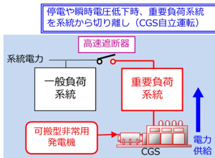
図 2.2 本田技研工業狭山工場における瞬低時・停電時の対応
