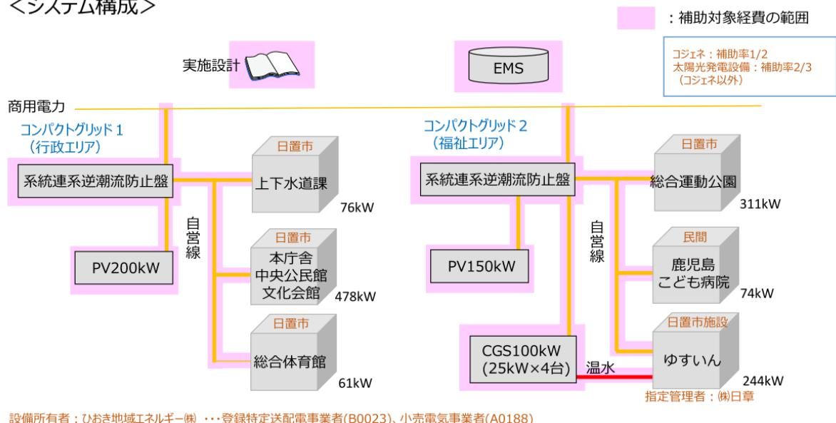
図 2.18 ひおきコンパクトグリッドのシステム構成
