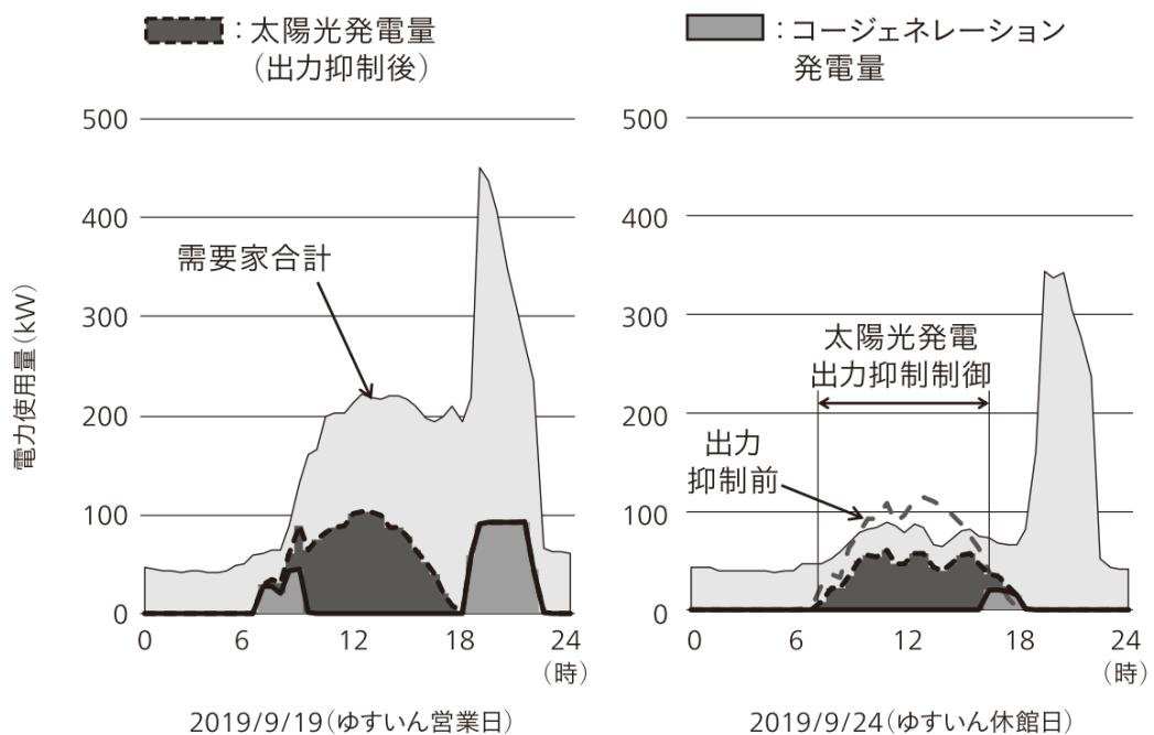
図 2.19 太陽光発電及びコーチェネレーションの運用事例
