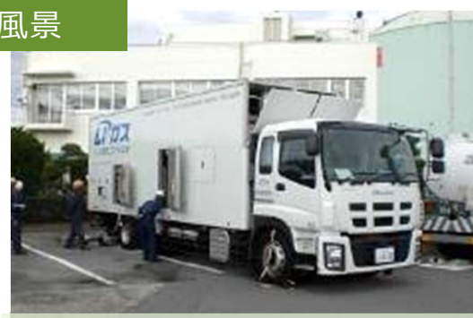
搭載された発電機から電力供給
