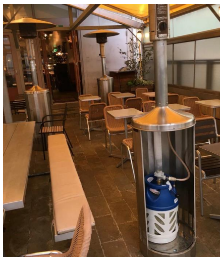
図 3.6 FRP 容器の利用事例（パラソルヒーティング）
