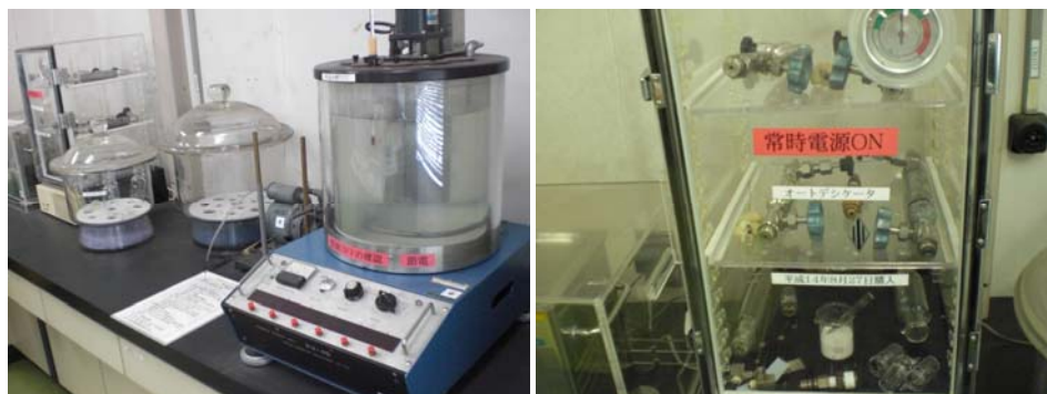
残渣分蒸発試験法(既存法)試験器具、作業工程が多く時間がかかる
