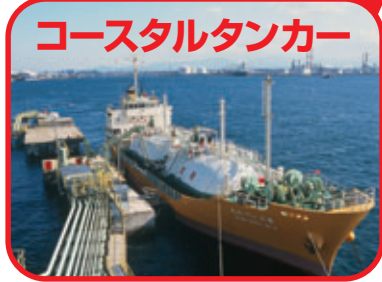
一次基地から二次基地までLPガスを運びます。
