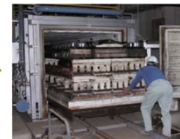
窯業用LPガス炉
